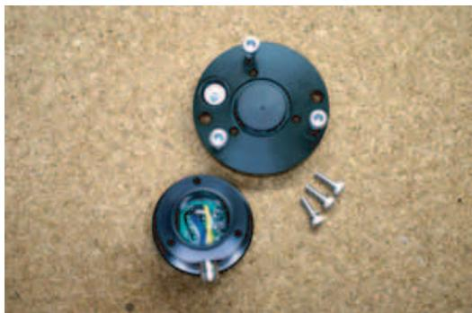
3. コネクタを下に見て右下にトリマが配置されています。マイナスインドクタ0.9~1.2mmのマイナスインドクタ(眼鏡用など)を使います。写真の状態時計回りがゲイン増加、反時計回りが減少です。
