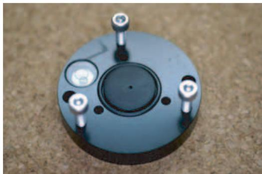
5. 水平器を図のように逆さまにし、プラスチックキャップを引き抜きます。へりに爪をかけ、鉛直下向きに引き出します。
