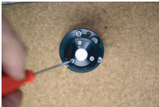
8. 青フィルターと拡散板の内側は触れないように注意します。拡散板の下にOリングがありますので、紛失に注意してください。
