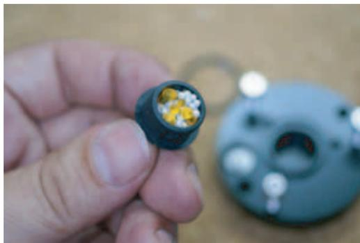
7. 拡散板は容易に交換できます。大きな傷などを付けてしまった場合以下の手順で交換します。交換による校正値のずれは $\pm 5 \mu E$ 未満です。対辺2.5mmのヘックスレンチを使って、トップカバーのネジ3カ所を外します。
