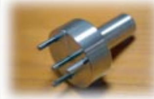
ニードル打ち込み治具
